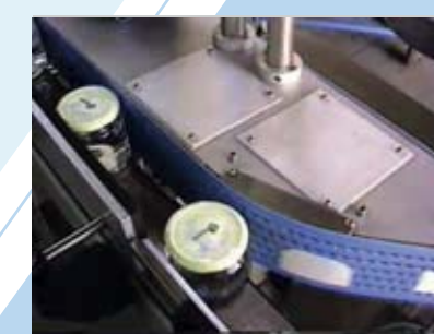
■ Rotolatore ad aspirazione MR13 ■ Vacuum wrap-around unit MR13 ■ Banderoleur à aspiration MR13
