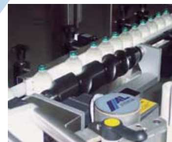
■ Distanziatore a coclea MD14 ■ Timing screw MD14 ■ Espaceur à vis sans fin MD14
