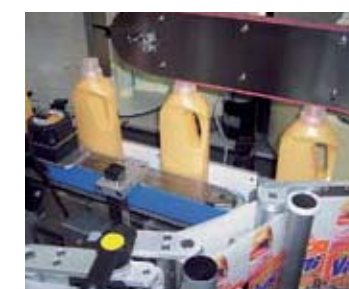
■ Allineatore a cinghia ME11 ■ Side-belt aligner ME11 ■ Orientation à courroie ME11
