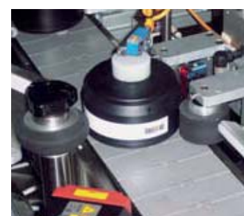
■ Unità per etichettatura in fase MR16 ■ In-phase labeling unit MR16 ■ Dispositif pour étiquetage in phase MR16
