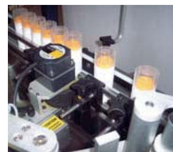
■ Distanziatore a rullino MD12 ■ Infeed gapping wheel MD12 ■ Espaceur à rouleau MD12
