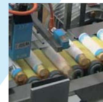
■ Controllo avvenuta etichettatura CS03-CS04-CS05 ■ Label presence control CS03-CS04-CS05 ■ Contrôle étiquetage arrivè CS03-CS04-CS05
