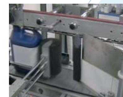
■ Pistone per piega etichetta AS08 ■ Label bending piston AS08 ■ Adaptateur pour pliage étiquette AS08
